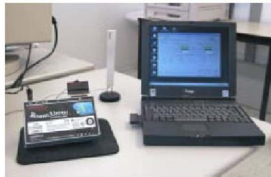
Abb. 1: WLAN-Komponenten: Access Point mit WLAN-PCMCIA-Karte und externer Zimmerantenne sowie Notebook mit WLAN-Karte
