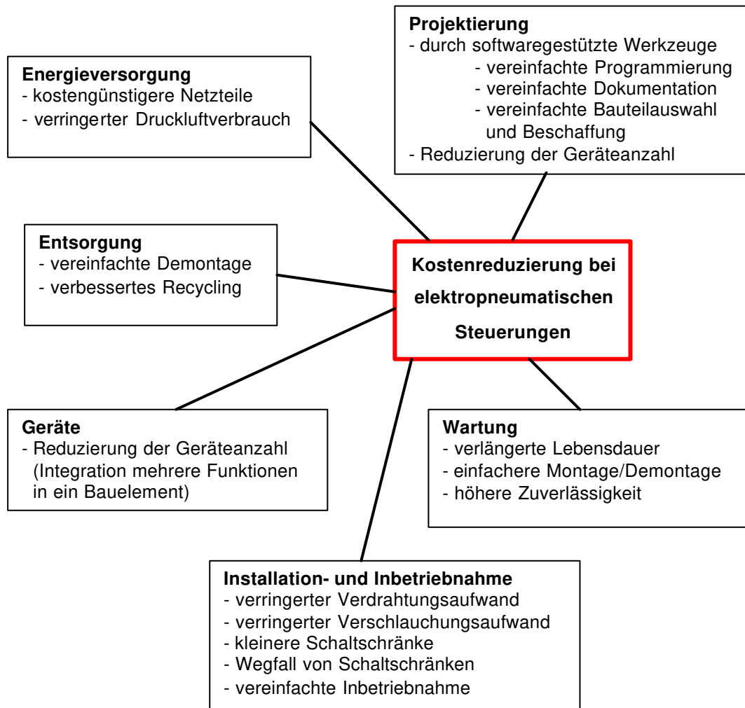
Abb.3.13: Kostenreduzierung bei elektropneumatischen Steuerungen
